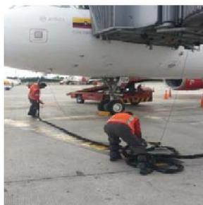
5. Enganchar el cable al soporte asegurando los ganchos **en los 3 puntos de sujeción que existen** y realizar ascenso desde la botonera ubicada en el soporte de las llantas del puente de embarque, hasta que el cable llegue hasta su punto de reposo.
