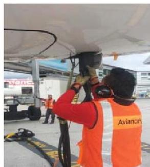
4. Finalizada la operación, el operario debe retirar el cable del avión y recoger el cable hasta su enganche, **evitando arrastrar el conector.**
