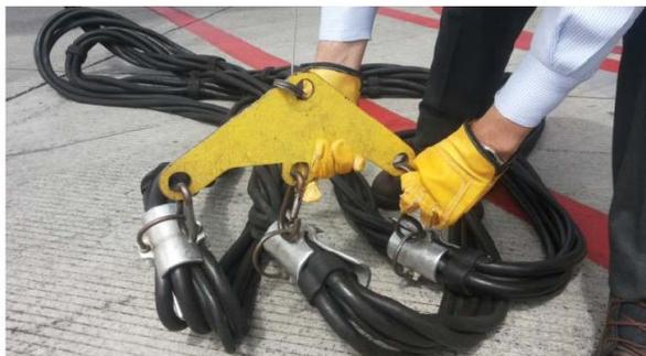
3. El operario deberá levantar el conector del cable de la GPU hasta la conexión del avión, **evitando arrastrar el conector.**
